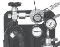
冬季等、気温が低い場所でロウ付けする場合、酸素圧力を上げることで、火力の低下を防止することができます。
