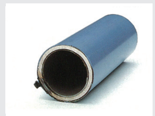
砥石切断機による切断パイプ見本
