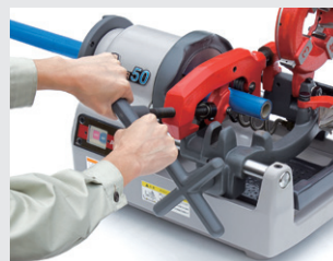
パイプカッタによる切断風景
